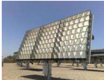
Fig. 26. Detalle de un array de concentradores XR para CPV desarrollados por Boeing
